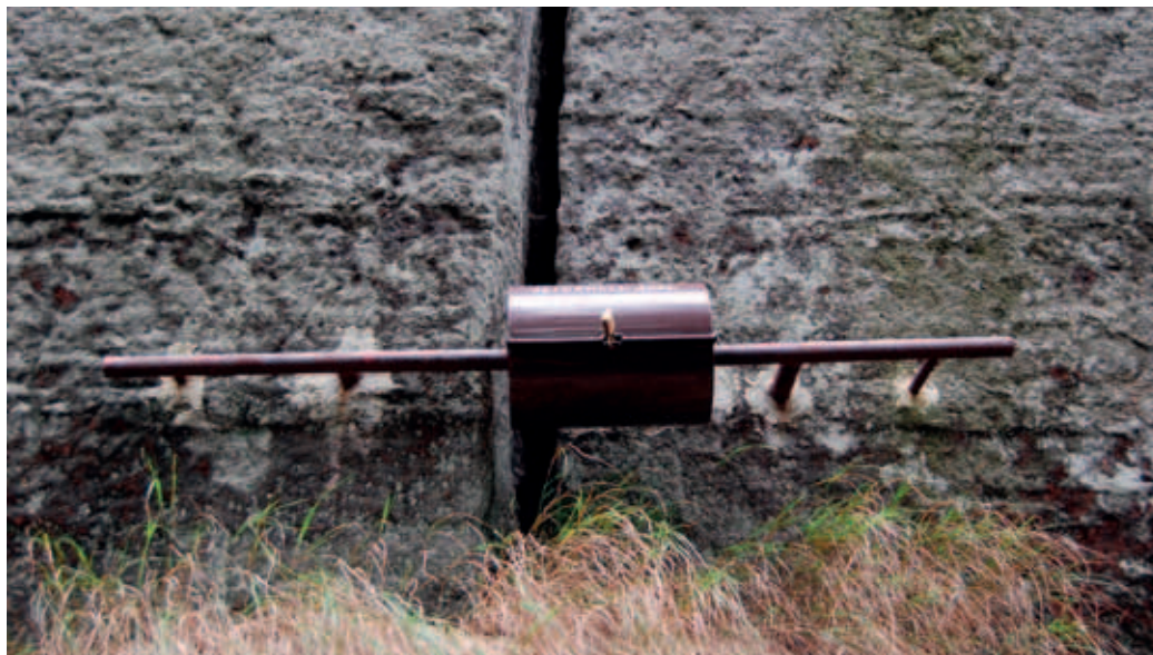
Ryc. 95. Szczelinomierz do pomiaru tempa rozwierania się szczelin w masywie piaskowcowym.
