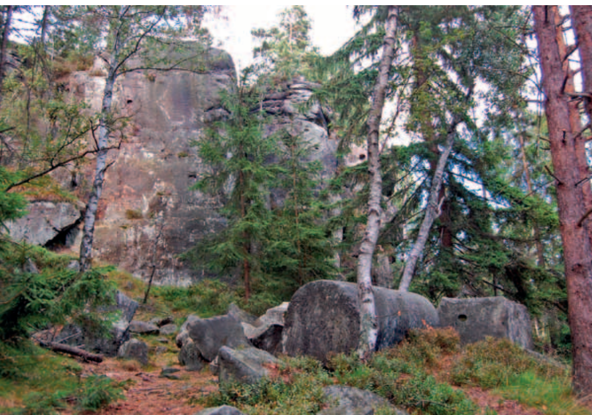
Ryc. 83. Dawna półka eksploatacyjna kamieniołomu, z pozostawionymi, częściowo obrobionymi blokami piaskowca.
